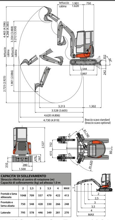
La capacità di sollevamento è basata sulla norma ISO 10567 e non eccede oltre il 75% del carico statico di ribaltamento o dell'87% della capacità di sollevamento idraulico della macchina.
